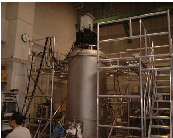
図 5.28: JAXA 宇宙科学研究本部の液体ヘリウム試験チャンパー
