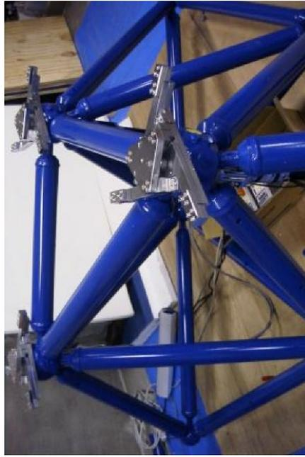
図 27: アクチュエータをトラス構造物に取りつけた写真
